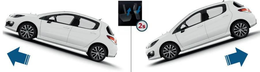
**En una pendiente ascendente, con el vehículo parado, este se mantiene un momento después de soltar el pedal del freno:**
