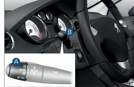
El mantenimiento temporal de las luces bajas encendidas después de haber cortado el contacto facilita la salida del vehículo cuando la luminosidad es reducida.
