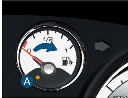
Muestra el nivel de combustible en el depósito cuando se pone el contacto en la posición 2.
