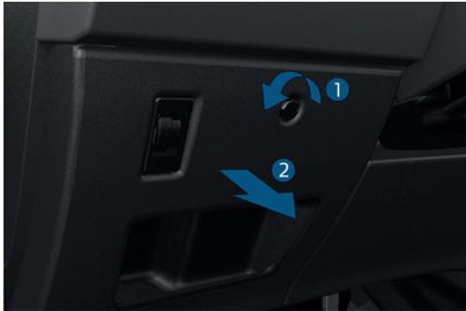
Los fusibles de recambio están instalados en el dorso de la tapa de la caja de fusibles del tablero.
