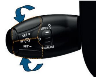
Esta tecla le permite seleccionar un umbral de velocidad memorizado para utilizarlo con el limitador de velocidad o con el regulador de velocidad.
