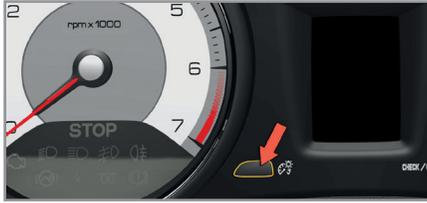
Permite regular manualmente la intensidad luminosa del puesto de conducción en función de la luminosidad exterior. Sólo funciona cuando las luces están encendidas en modo noche.
