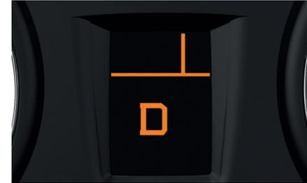
Cuando se desplaza la palanca por la rejilla para seleccionar una posición, el testigo correspondiente se enciende en el tablero de instrumentos.
