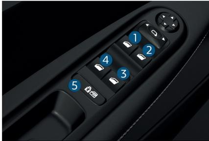
1. Interruptor de levantavidrios eléctrico del conductor
