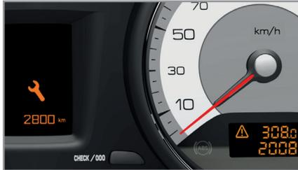
Esta información se muestra durante unos segundos al poner el contacto. Informa al conductor de cuándo debe efectuar la siguiente revisión, conforme al plan de mantenimiento del fabricante.
