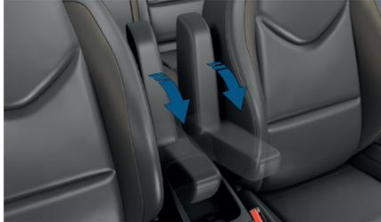
Mover para abajo, colocándolo en posición de uso. Para poner el apoyabrazos en la posición vertical, levantarlo y empujarlo hacia atrás, pasando el punto de resistencia.
