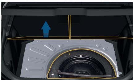
El herramental está instalado en el baúl, abajo de la alfombra y sobre la rueda de auxilio.
