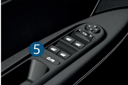
☞ Por la seguridad de los niños, presione en el interruptor **5** para neutralizar los interruptores de levanta-vidrios traseros independientemente de su posición.
