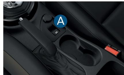
☞ Para conectar un accesorio de 12 V (potencia máxima: 120 vatios), abra la tapa y conecte el adaptador adecuado. Esta toma permite conectar un cargador de teléfono, un calentador de mamaderas por ejemplo.
