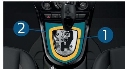
Desmontar el embellecedor **1** y después el embellecedor **2** con cuidado para evitar que se rompa.
