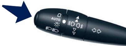
Si el vehículo no tiene este botón en los mandos del volante, presione el extremo de la palanca del mando de iluminación para activar el reconocimiento vocal.
