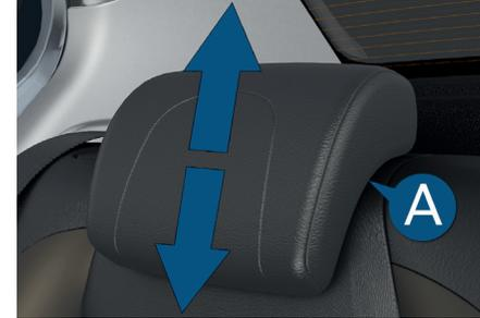
Cuentan con una única posición de uso (alta) y una posición de reposo (baja). Los apoyacabezas son desmontables y pueden intercambiarse con otros de la misma fila.
