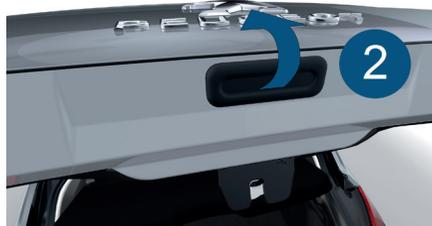
Para una mejor protección antirrobo de la rueda de auxilio, en caso de acceso al interior del vehículo sin la utilización del mando a distancia de la llave o de la cerradura de la puerta, la apertura del portón del baúl estará bloqueada.
