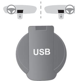
Esta toma está destinada únicamente a la alimentación y a la recarga del dispositivo portátil conectado.
