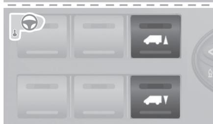
Dispone de un nivel nominal y de 6 niveles de variación del umbral en elevación (de +1 a +3) o en bajada (de -1 a -3). Cada nivel alcanzado se indica en la pantalla del cuadro de instrumentos.
