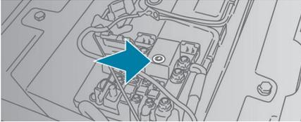
☞ A continuación, para restablecer la alimentación eléctrica, pulse el segundo botón, situado en el compartimento de la batería bajo el suelo (minibús).
