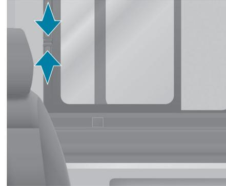
Según el equipamiento del vehículo, las ventanillas laterales se pueden abrir. Presione los dos mandos y después deslice la ventanilla.
