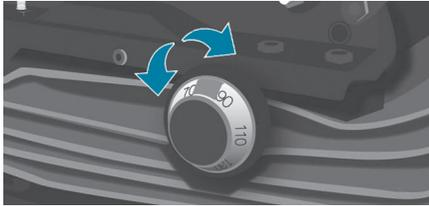
☞ Si su asiento está equipado, gire el botón para ajustar la amortiguación en función del peso del conductor.
