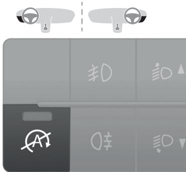
☞ Pulse de nuevo este botón. El sistema volverá a activarse. Esto se confirma mediante el apagado del testigo del botón acompañado de un mensaje.
