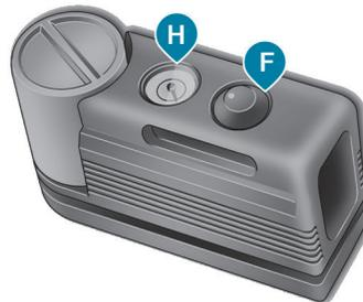
☞ Asegúrese de que el interruptor **F** del compresor está en la posición **0** (apagado).
