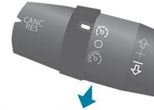
Desplace el mando hacia arriba (+) o hacia abajo (-) para memorizarla. Un mensaje en la pantalla del cuadro de instrumentos confirma la activación.
