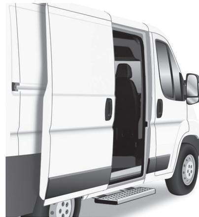
Para facilitar el acceso y la salida de los pasajeros traseros, el vehículo puede ir equipado con un estribo que se despliega al abrir la puerta lateral corredera.
