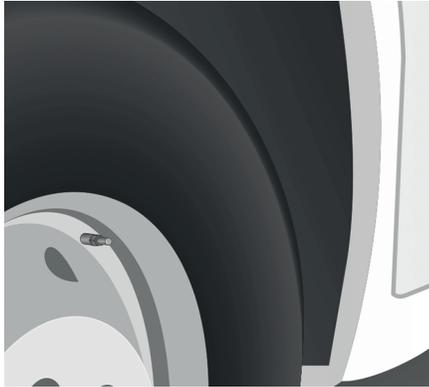
Sistema que controla automáticamente la presión de los neumáticos durante la conducción. El sistema vigila permanentemente la presión de los cuatro neumáticos, desde el momento en que el vehículo se pone en movimiento. Las válvulas de los neumáticos llevan instalados sensores de presión (salvo en la rueda de repuesto). El sistema activa una alerta en cuanto detecta que la presión de inflado de uno o varios neumáticos es insuficiente.
