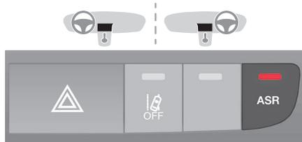
☞ Pulse este botón para desactivar el sistema. El encendido de este testigo acompañado de un mensaje en la pantalla del cuadro de instrumentos indica que el sistema ASR está desactivado.
