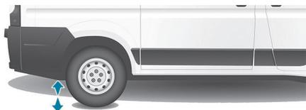
Si el vehículo está equipado con suspensión neumática, es posible modificar la altura del umbral trasero para facilitar la carga o descarga.
