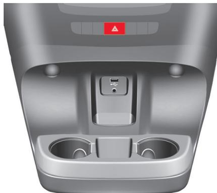
Dispone de un espacio de almacenamiento abierto, situado bajo el panel de la consola central. Este permite acceder a las tomas auxiliares (Jack y USB) específicas para la transferencia de datos hacia el sistema de audio. Según el equipamiento, también está equipado de un portavasos doble y/o de un soporte para el smartphone.
