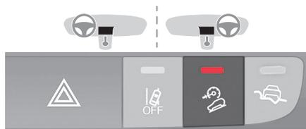
☞ A una velocidad inferior a 30 km/h, pulse este botón para activar el sistema; el testigo del botón se enciende.
