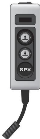
Se sube o se baja pulsando los botones correspondientes del telemando imantado y amovible, situado en un soporte en la cabina. La elevación del volquete es controlada por el motor de la unidad electrohidráulica. La bajada es controlada por una electroválvula que abre el retorno de aceite del cilindro. Un dispositivo de seguridad impide la bajada del volquete cuando no está en movimiento ni se está elevando.
