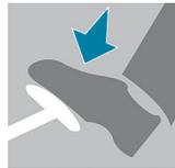
Pise **con firmeza** el pedal del acelerador, rebasando el **punto de resistencia**, para superar el límite de velocidad programado.
