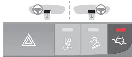
☞ Pulse este botón para desactivar el sistema; el testigo del botón se apaga y el sistema **ASR** vuelve a estar activo.
