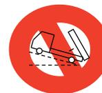
Vuelque la carga en una superficie llana y resistente: una superficie resbaladiza o suelta podría modificar el centro de gravedad y provocar la inestabilidad de todo el vehículo.
