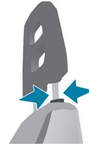
☞ Pulse la lengüeta para ajustar la altura del reposacabezas.
