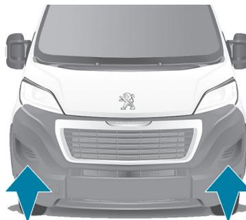
Los escalones, situados en el paragolpes delantero, le permiten acceder a las escobillas y a los pulverizadores del lavaparabrisas.
