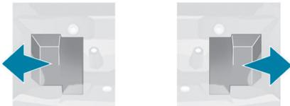
Situadas en los extremos de cada bloque óptico, van fijadas al panel delantero por encima del radiador. Para retirarlas, deslícelas lateralmente hacia el exterior del vehículo.
