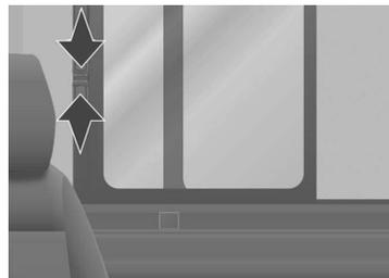
Según el equipamiento del vehículo, los vidrios laterales de la fila 2 se pueden abrir. Presione los dos mandos y después deslice el vidrio.
