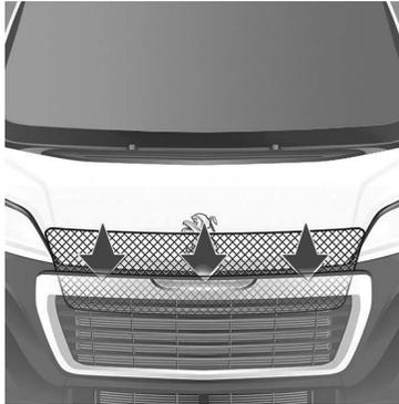
Según el país de comercialización, una rejilla antiproyecciones, fijada en el interior del paragolpes delantero, permite proteger los componentes del compartimento motor de las proyecciones de gravilla...
