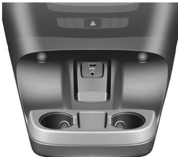
Existe un espacio para almacenar abierto bajo el panel de la consola central. Proporciona acceso a tomas auxiliares (conector y USB) destinadas a transferir datos al sistema de audio. Según equipamiento, también puede contar con soporte para bebidas doble, un soporte para teléfonos o ambos.
