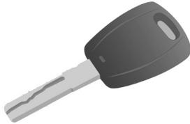
Permite bloquear y desbloquear las cerraduras del vehículo, abrir y cerrar el tapón del depósito de carburante y arrancar y apagar el motor.
