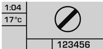
Mediante la cámara situada en la parte superior del parabrisas, este sistema detecta los siguientes tipos de señales y muestra la información correspondiente en el cuadro de instrumentos:
