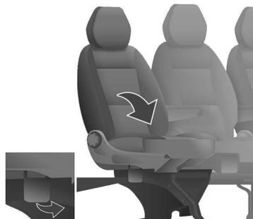
► Para acceder a la tercera fila, accione el mando del asiento lateral de la segunda fila e incline el respaldo hacia delante.
