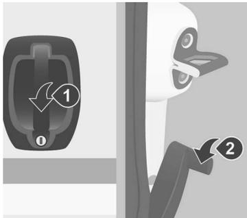
► Tire del tirador hacia usted y, a continuación, tire de la palanca para abrir la puerta izquierda. Ambas puertas se abren 96°.
