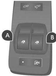
**A. Levantavidrios eléctrico del conductor**
