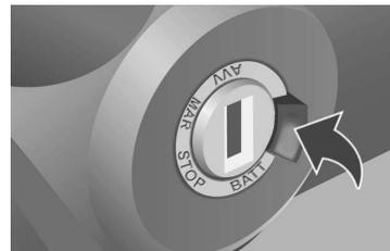
► Pulse el botón rojo y, a continuación, gire la llave hasta la posición **BATT**. Unos 7 minutos después la batería entra en modo en espera.
