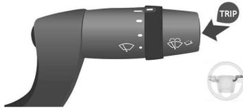
► Para acceder al ordenador de abordó, pulse el botón **TRIP** situado en el extremo de la palanca de control del limpiaparabrisas.
