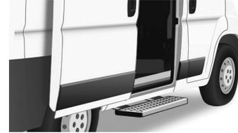
Para facilitar el acceso y la salida de los pasajeros traseros, el vehículo puede equiparse con un estribo que se despliega al abrir la puerta lateral corredera.
