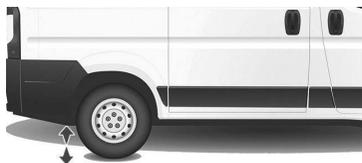
Si el vehículo está equipado con suspensión neumática, es posible modificar la altura del umbral trasero para facilitar las operaciones de carga y descarga.
