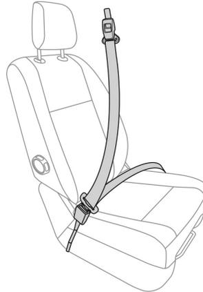
Los cinturones de seguridad delanteros están equipados con un sistema de pretensión pirotécnica y un sistema de limitación de esfuerzo.
