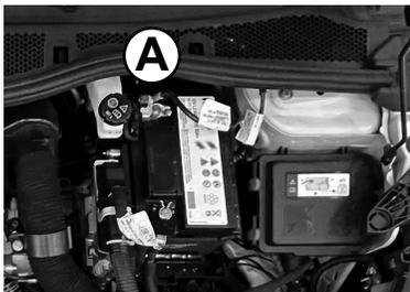
**i** El sensor IBS de la batería principal, indicado por la flecha, no puede nunca ser desconectado del polo negativo, excepto en el caso de sustitución de la batería principal.
