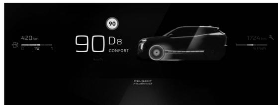
Indicación de cargando la batería auxiliar de litio (e-Regen) (verde)
