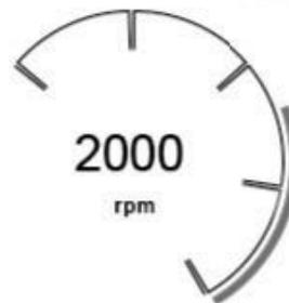
**!** Al acercarse al límite máximo de revoluciones **A**, el sistema de inyección electrónica corta el flujo de combustible para protección del motor. Este corte de combustible ocasiona pérdida de potencia del motor.
