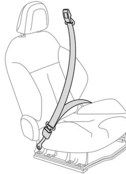
Los cinturones de seguridad están equipados con un carrete que permite ajustar automáticamente la longitud del cinturón al tipo físico del usuario. El cinturón de seguridad vuelve automáticamente a su posición original cuando no está en uso.
