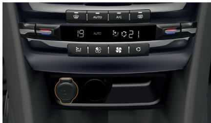
Para conectar un accesorio de 12 V (potencia máxima: 120 vatios), abra la tapa y conecte el adaptador adecuado.
