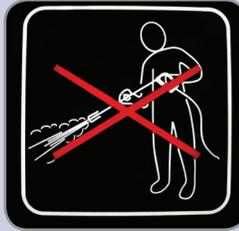
Para no dañar los órganos eléctricos, está totalmente **prohibido** el lavado a alta presión en el compartimento motor..
