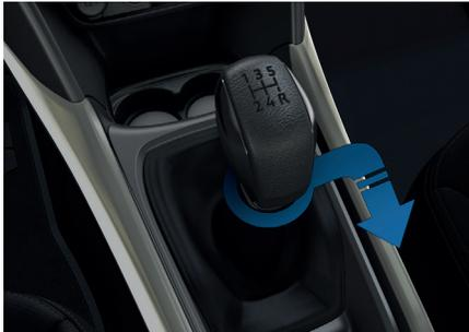
☞ Empuje la palanca de cambios hacia la derecha y luego hacia atrás. Introduzca la marcha atrás únicamente con el vehículo parado y el motor al ralentí.
