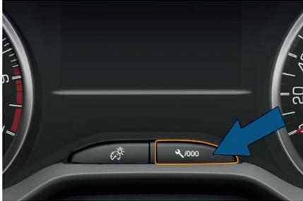
Después de cada revisión, debe poner a cero el indicador de mantenimiento.
