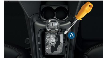
Desbloquear el "shift-lock" presionando en **A** con un destornillador .
