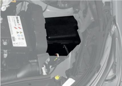
La caja de fusibles está situada en el compartimento motor, cerca de la batería (en el lado izquierdo).
