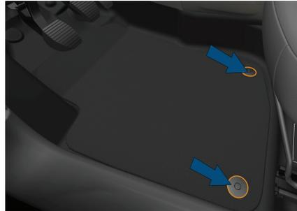
Para el primer montaje de la cubrealfombra del lado del conductor, utilice exclusivamente las fijaciones que se incluyen.
