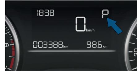
Cuando se desplaza la palanca por la rejilla para seleccionar una posición, el testigo correspondiente se enciende en el tablero de instrumentos.
