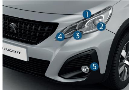
1. **Luces diurna/de posición (diodos electroluminiscentes-LED).**
