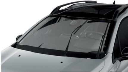
Esta posición permite separar las escobillas del parabrisas delantero.
