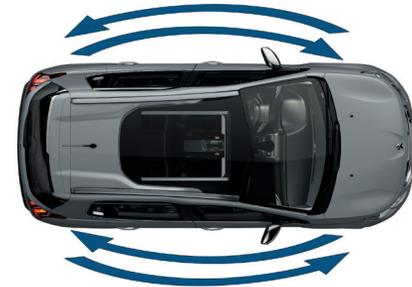
**/** No efectuar rotación cruzada de los neumáticos, desplazando ellos en el lado derecho del vehículo a la izquierda y viceversa.vice-versa.
