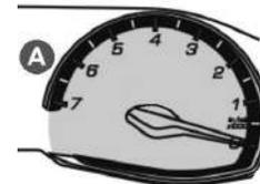
! Al acercarse al límite máximo de revoluciones **A**, el sistema de inyección electrónica corta el flujo de combustible para protección del motor. Este corte de combustible ocasiona pérdida de potencia del motor.
