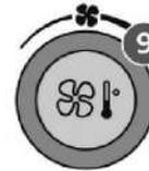
Pulsando el botón 6 es posible seleccionar la reglaje del caudal de aire o la reglaje de la temperatura, y después girando el botón 9.
