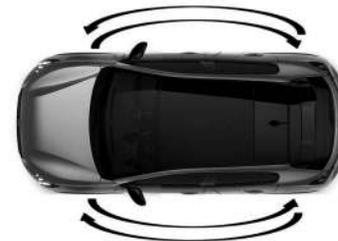
**!** No efectúe la rotación transversal de los neumáticos, moviéndolos del lado derecho del vehículo al izquierdo y viceversa.
