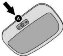
Soltar la tapa del plafón trasero con un destornillador fino en el punto A, para acceder a la lámpara defectuosa.
