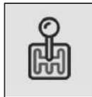
**Cambio de marcha** - Evite forzar las marchas; realice los cambios cerca de los **2.500 RPM** (revoluciones por minuto) y si su vehículo tiene el **GSI** (Indicador de Cambio de Marchas) siga las indicaciones presentadas en el panel de su vehículo.
